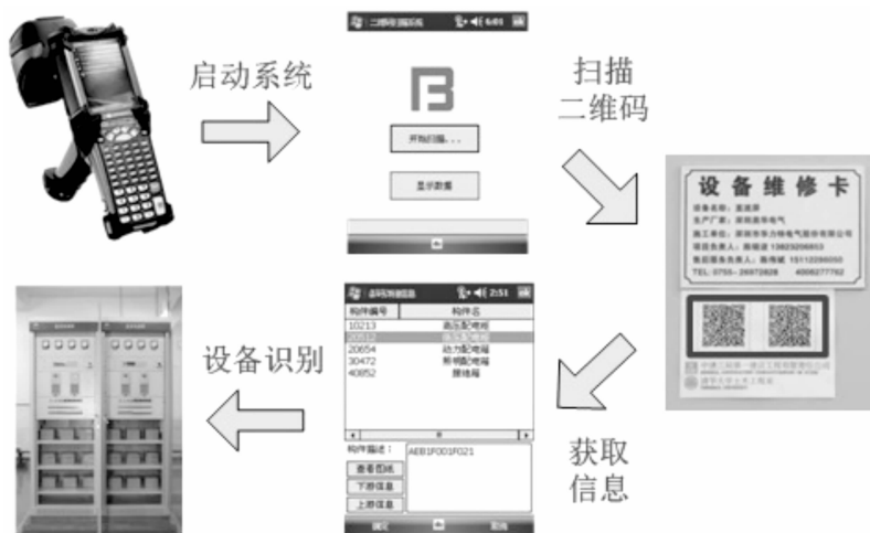
图 6-4 基于二维码的设备识别与信息提取
