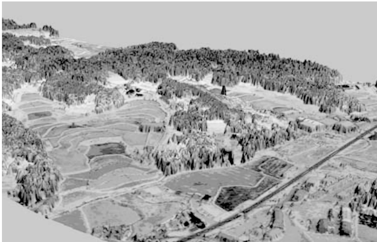
图 4-1 三维激光扫描地形数据信息
