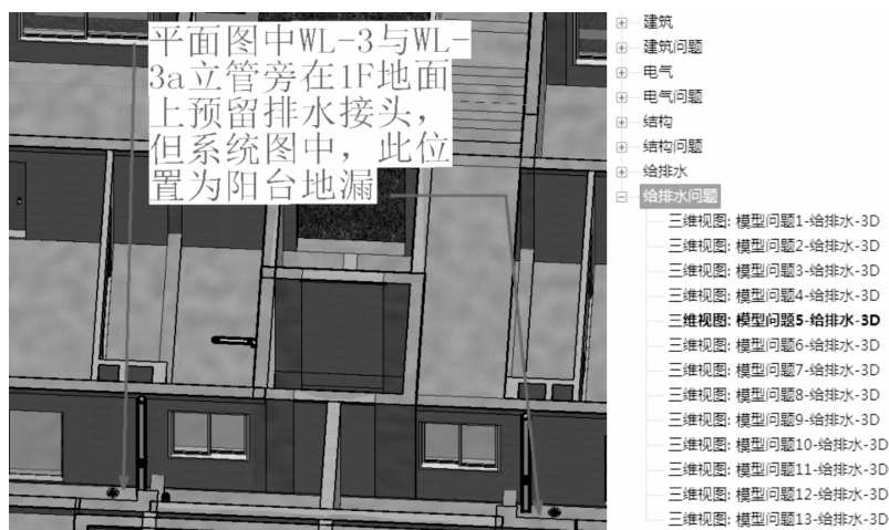
图 4-13 设计校核模型三维视图中标注的问题
