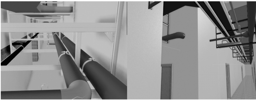
图 3-52 加入支吊架后管线布置深化分析
